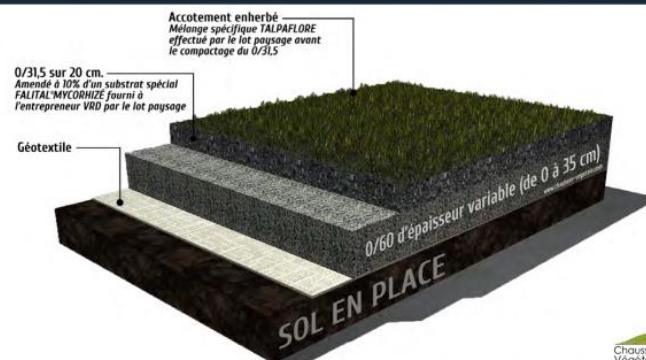
COUPE D'UN ACCOTEMENT / STATIONNEMENT ENHERBÉ
